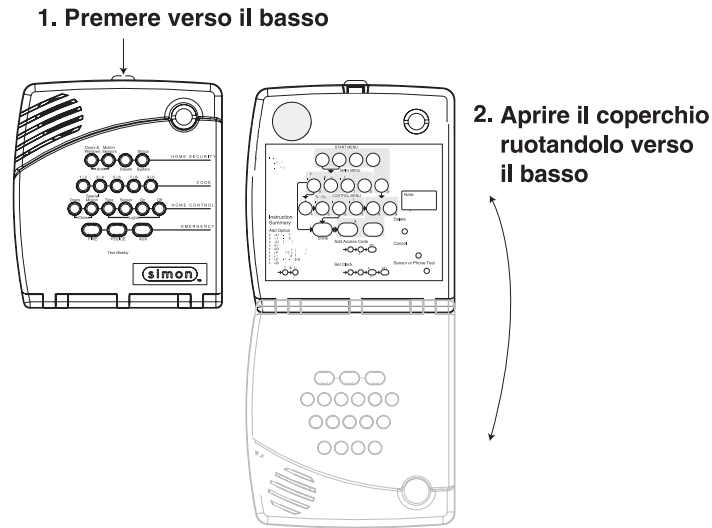
Figura 1. Apertura del coperchio della centrale d'allarme
